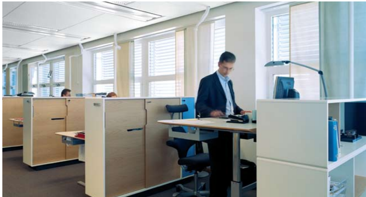
La propagation du son dans les espaces ouverts est réduite en combinant plafond acoustique et meuble de rangement (h = 1,4 m) entre postes de travail. ITT Flygt, Stockholm. Architecte : Strategisk Arkitektur. Photo : Åke E:son Lindman
