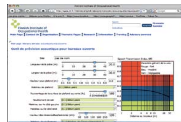
Fig. 4 : Copie d'écran du site de l'Institut Finlandais de Santé au Travail pour la prévision simplifiée de l'acoustique des bureaux ouverts. En paramétrant les caractéristiques de la pièce, l'outil calcule la valeur d'indices simples comme le rayon de discrétion. L'outil est disponible en finnois, anglais et français. http://www.ttl.fi/internet/english/advisory-services/acoustiquebureauxouverts.htm#
